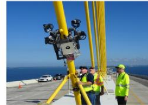
Метода расипања магнетног поља примена на: Претходно напрегнутом носачу Косим затегама
