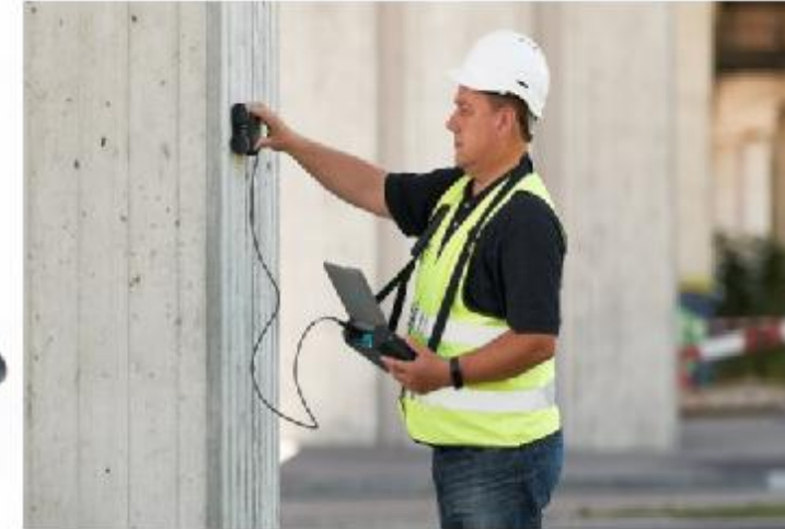
Метода расипања магнетног поља примена на: Претходно напрегнутом носачу Косим затегама
