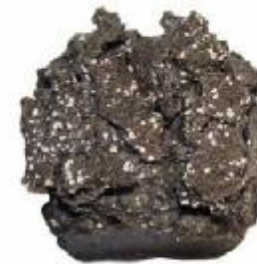
Разарање бетона узроковано таумаситом
